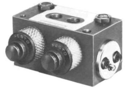
Die Umsteuerung des Ventils erfolgt wahlweise von Hand durch Schalthebel, mechanisch über Schaltstößel durch Betätigung der eingebauten 3/2-Wegeventile oder pneumatisch durch Signal auf Anschluß Y oder Z. Die Geschwindigkeit von Vor- und Rücklauf eines Zylinders wird durch Abluftdrosselung an den beiden Regulierverschrauben eingestellt.
