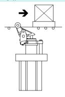
4. 通过弹簧力或气压将活塞伸 出。滚轮杠杆后翻,防止工 件承载装置被向上推起。 5. 通过弹簧力将滚轮杠杆向上 抬起,等待止动下一个工件 承载装置。
