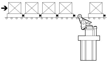
对于DFST-50, 传送速度为 15 m/min时的最大许用质量为320 kg。因为从止动气缸上前进的四个承载装置的总质量为400 kg, 所以必须为分离工序选择下一个最大的止动气缸。
