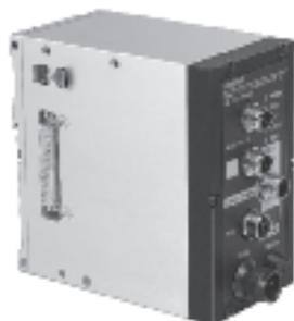
Diventa così possibile gestire indipendentemente fino a 128 ingressi e 128 uscite. Con il DeviceNet-Scanner dell'SF60 è possibile aggiungere e controllare altri I/O e funzioni più complesse. Il modulo di controllo SF60 può funzionare a scelta in modalità standalone, come slave o come master del DeviceNet (con max. 31 slave).
