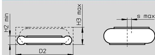
D2 diametro di montaggio necessario
