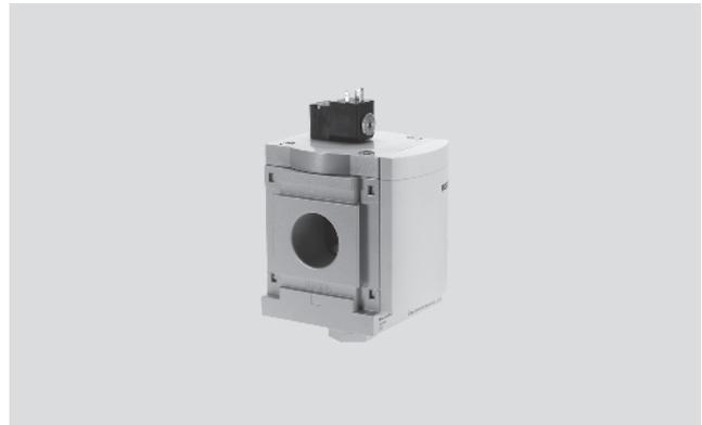
La durée de la mise en pression est réglée sur le réducteur de débit placé sur le couvercle du distributeur. En fonction de la position d'étranglement paramétrée, la pression de sortie p2 monte lentement. Tant que l'électrodistributeur n'est pas manipulé, seul le débit du réducteur est disponible. Le siège principal ne s'ouvre que lorsque l'électrodistributeur est alimenté.
