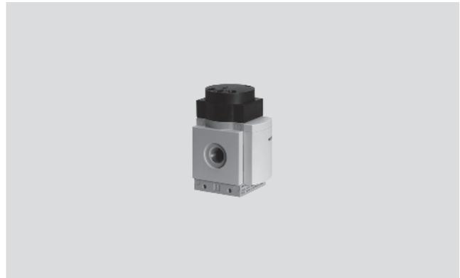
La durée de la mise en pression est réglée sur le réducteur de débit placé sur le couvercle du distributeur. En fonction de la position d'étranglement paramétrée, la pression de sortie p2 monte lentement. Lorsque la pression souhaitée est atteinte, le siège principal s'ouvre.
