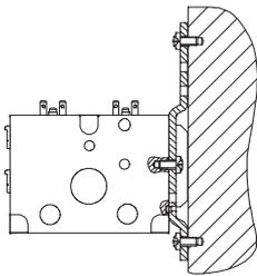
Para terminal de válvulas CPV10: CPV10/14-VI-BG-RWL-B (código U)
