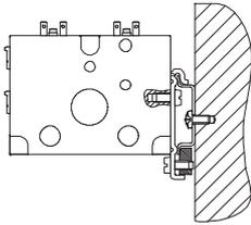
Para terminal de válvulas CPV10: CPV10/14-VI-BG-NRH-35 (código H)
