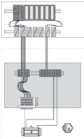
Terminal de válvulas seguro en armario de maniobra. Transmisión de señales a través de cable multifilar.
