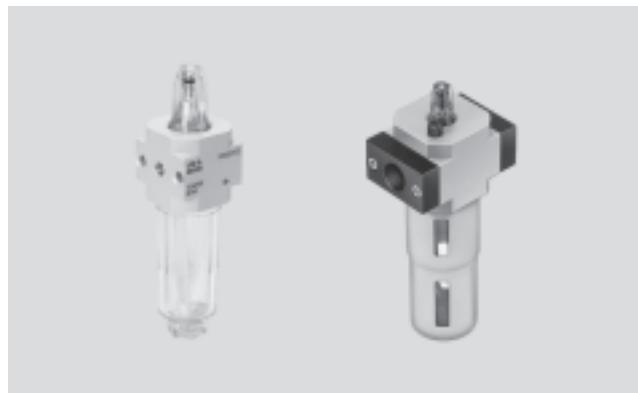
El lubricador proporciona dosificación exacta de aceite mezclándolo con el aire a presión. La caída de presión que se produce al pasar el aire por una tobera Venturi sirve para elevar el aceite desde el depósito hasta la campana de goteo. Desde allí las gotas de aceite fluyen al aire, donde se nebulizan. La cantidad de aceite nebulizado es proporcional al caudal de aire a presión.
