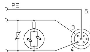
KMEB-1/KMEB-3 sin indicación integrada del estado de conmutación
