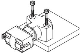
Mediante taladros, tornillos y tuercas de fijación
