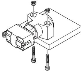
Fijación con brida, tornillos y pasadores cilíndricos
