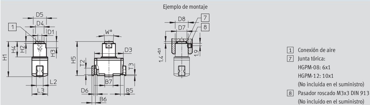
Con fijación por brida: HGPM-...-E...-G9
