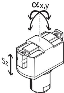
Las pinzas paralelas tienen una holgura entre los dedos y el elemento de guía debido al sistema de guía de deslizamiento. Los valores que constan en la tabla siguiente fueron calcula-
