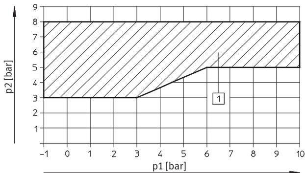
1) Arbeitsbereich für Ventile mit Steuerluftversorgung extern
