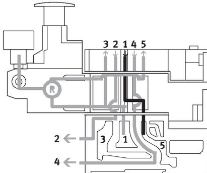
Der reversible A-Regler splittet die Arbeitsluft im Kanal 1 auf und regelt den Druck vor dem Ventil in den Kanal 5 (im Kanal 3 steht der unregelte Druck aus Kanal 1 an). Danach wird die geregelte Luft auf den Kanal 4 geregelt. Das Ventil wird dadurch reversibel betrieben.
