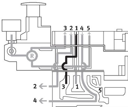
Der reversible B-Regler splittet die Arbeitsluft im Kanal 1 auf und regelt den Druck vor dem Ventil in den Kanal 3 (im Kanal 5 steht der unregulierte Druck aus Kanal 1 an). Danach wird die geregelte Luft auf den Kanal 2 geregelt. Das Ventil wird dadurch reversibel betrieben.
