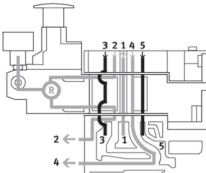
Dieser Druckregler regelt den Druck im Kanal 2 nachdem das Druckmedium durch das Ventil geströmt ist. Beim Entlüftungsvorgang wird im Ventil über den Druckregler von Kanal 2 nach Kanal 3 entlüftet.
