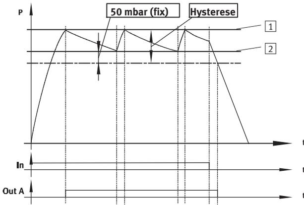
Ist der gewünschte Schwellwert [1] für das Vakuum erreicht wird die Vakuumerzeugung selbstständig ausgeschaltet. Ein Rückschlagventil verhindert den Abbau des Vakuums. Durch Leckage (z. B. raue Werkstückoberflächen) wird das
