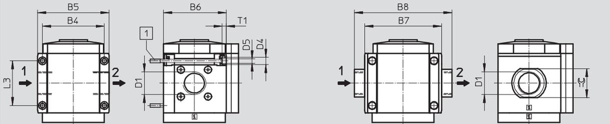
1 Befestigungsschraube M6xmin.90 nach DIN 912 (nicht im Lieferumfang enthalten) zur Wandmontage ohne Befestigungswinkel
