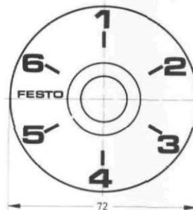
Die selbstklebende Skalenscheibe hat einen Durchbruch von 18 mm  $\varnothing$ . Durch Ausbrechen eines vorgeritzten Ringes läßt sich der Durchbruch auf 28 mm  $\varnothing$  erweitern.
