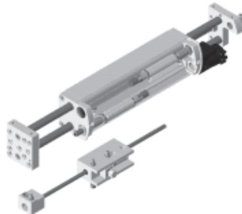
Eine Feststellpatrone blockiert durch eine reibschlüssige Verbindung die Klemmstange (Sicherheit bei Druckausfall). Die Klemmstange wird an der Frontplatte montiert. Bei Druckbeaufschlagung
