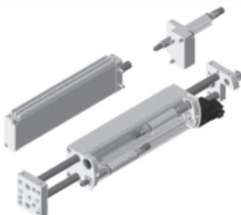
Durch einen zusätzlich angebauten Zylinder und einem zusätzlichen Anschlagelement kann eine beliebige Position zwischen den beiden Endlagen des Linearmoduls frei angefahren werden.
