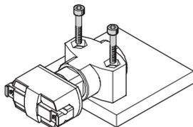
Mit Durchgangsbohrung, Schrauben und Befestigungsmutter
