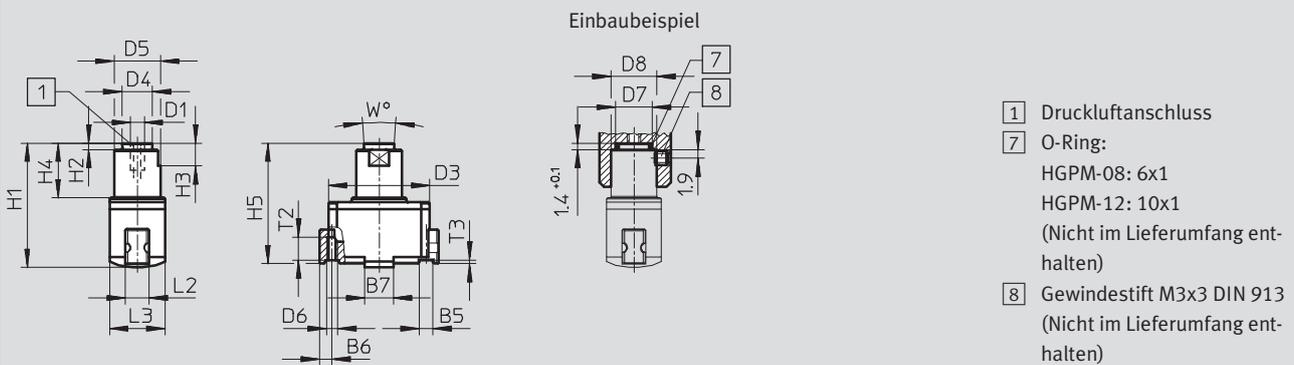
Mit Flanschbefestigung – HGPM-...-E...-G9
