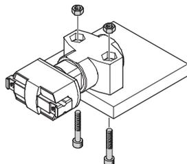
Mit Flanschbefestigung, Schrauben und Zylinderstifte
