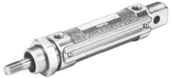
An dem Zylinder können ein oder mehrere Näherungsschalter auf der DUO-Schiene festgeklemmt werden. Mit den Schaltern lassen sich die Endlagen oder Zwischenstellungen des Zylinders berührungslos abtasten.
