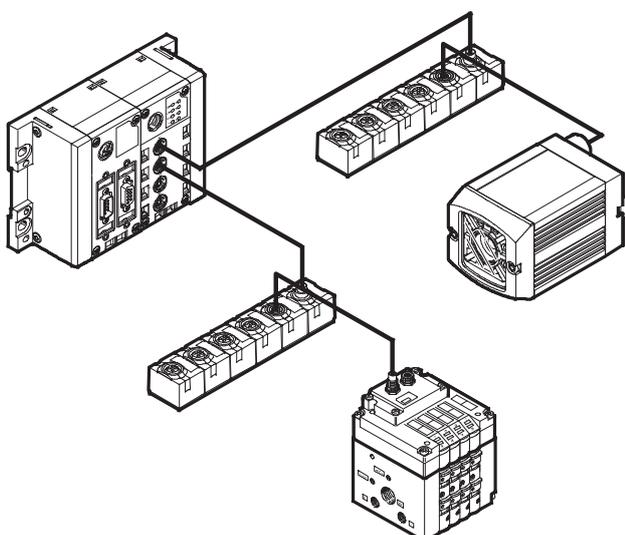
Das Kompaktkamerasystem SBOx-Q kann in ein Festo CPI-Netzwerk integriert werden. Dabei verhält es sich wie ein binäres Modul mit je 16 Ein- und Ausgängen. In Verbindung mit z.B. einem CPX-CPI Modul und einem CPX Feldbusknoten kann auf die Kamera über Profibus-DP, Interbus, DeviceNet, CANopen and CC-Link zugegriffen werden.
