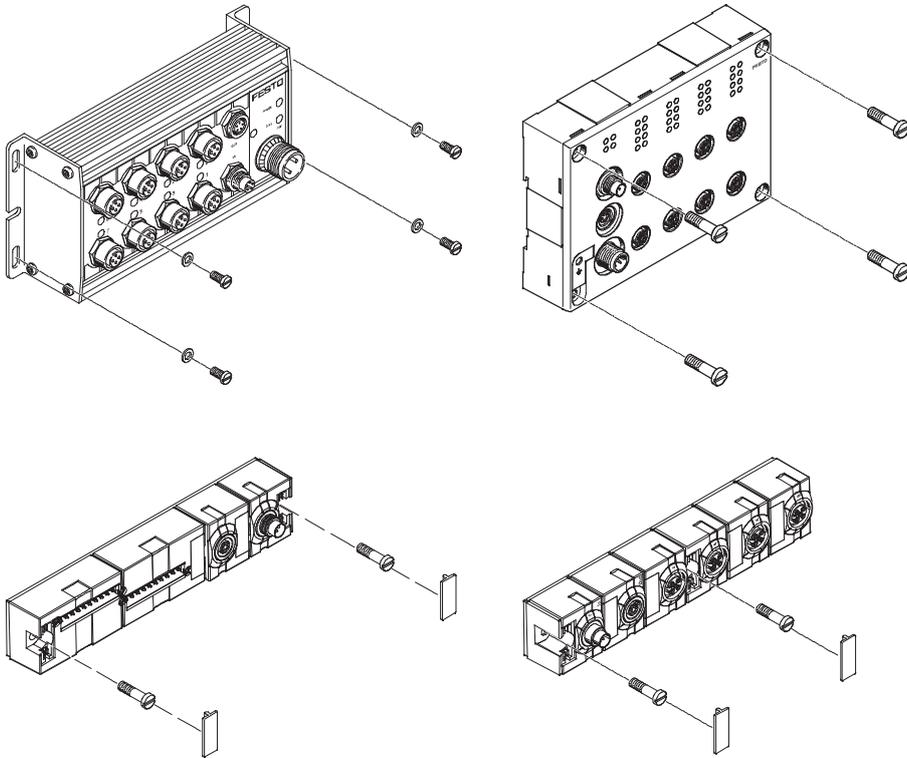
Über vorhandene Montagebohrungen lassen sich die CP-Module (mit Schrauben bis  $\varnothing 4$  mm) in nahezu jeder beliebigen Lage an ebenen Flächen montieren.
