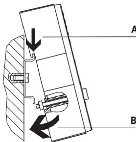
Im rückwärtigen Profil der wirtschaftlichen CP-Module ist die Hutschienenmontage eingepreßt. Über die Hutschienenbefestigungen lassen sich die Module auf der Hutschiene verriegeln.
