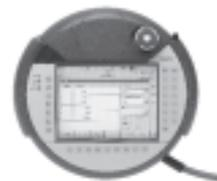
Bei der Erstellung eines Bewegungsprogramms ist sehr oft die Bewegungssequenz bekannt, die genaue Position die angefahren werden muss, z. B. Greifer- oder Ablageposition jedoch unbekannt. Diese können erst direkt bei der Inbetriebnahme durch ein genaues Anfahren bestimmt werden. Hierzu bietet die CMXR in Verbindung mit dem Bediengerät CDSA eine dialoggeführte Software, die ein leichtes und schnelles Teachen (einlernen) der erforderlichen Positionen ermöglicht.
