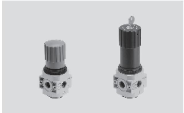
这种减压阀适用于集成安装，可提供各种不同压力的气源，每个减压阀的前后两边各有一个压力输出口。
