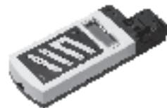
符合 SPEC V2.1 规定的地址设定器可以从网络任意一点介入并扫描 AS-i 地址情况。可对所有连接在网络上的站点进行:
