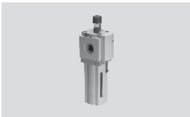
Il lubrificatore proporzionale immette nell'aria compressa una quantità di olio con dosaggio di precisione. La caduta di pressione che si verifica durante il flusso attraverso un ugello Venturi viene sfruttata per convogliare l'olio da un serbatoio allo sgocciolatoio. Da qui, la goccia d'olio fluisce brevemente dietro alla valvola proporzionale nel canale dell'aria, dove viene nebulizzata. La
