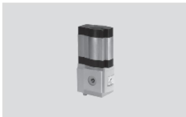
Il riduttore di pressione elettrico regola l'aria compressa in ingresso secondo la pressione di uscita impostata. Il riduttore di pressione mantiene costante la pressione di uscita, indipendentemente dalle eventuali oscillazioni di pressione dell'impianto e dal consumo di aria. L'unità di azionamento elettrico integrata permette una regolazione indiretta della pressione di uscita. L'unità di azionamento può essere
