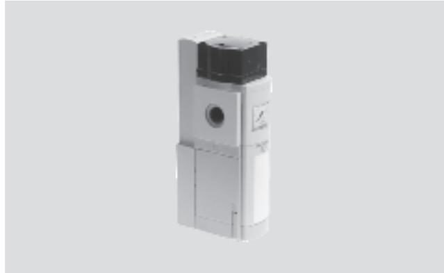
La valvola elettropneumatica di inserimento progressivo e di scarico serve per l'aumento graduale e lo scarico rapido e controllato della pressione nei sistemi pneumatici e impianti industriali. Si tratta di un sistema mecatronico ridondante con funzione di auto-test,
