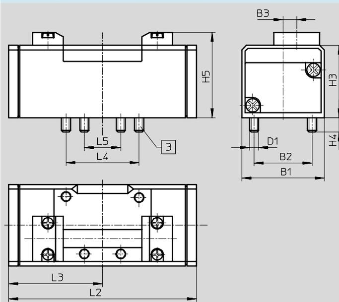
3 Viti di fissaggio antisifilamento
