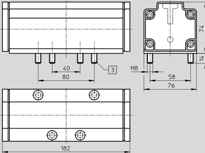
3 Viti di fissaggio antisfilamento
