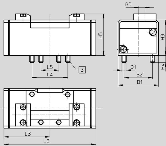
3 Viti di fissaggio antisfilamento
