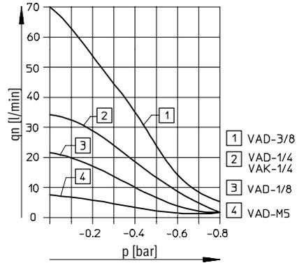
Capacité d'aspiration  $q_n$  en fonction de la pression de service p
