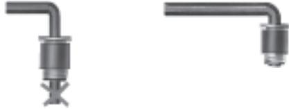
Avec les raccords enfichables Quick Star, veiller à ne pas engager la clé trop profondément dans le raccord
