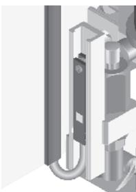
**1** Les câbles des capteurs de proximité sont posés dans les rainures profilées du couvercle latéral et de la plaque support.
