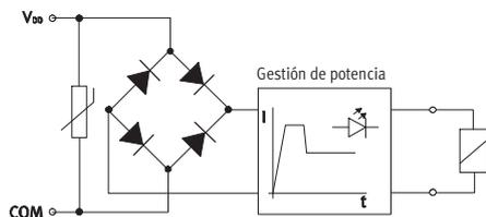
Cada bobina tiene un circuito protector para supresión de arco voltaico y, además, tiene polaridad inconfundible. Además, todas las válvulas están equipadas adicionalmente con una
