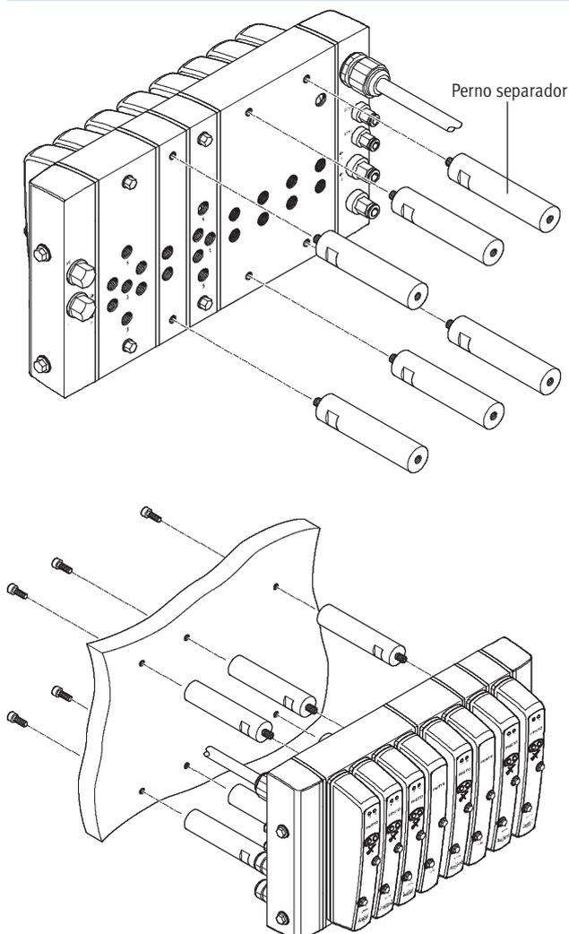
Recurriendo a los cuatro taladros rosados del bloque básico y utilizando los pernos (accesorio código Y) es posible montar el terminal DCVI directamente a las superficies conectadas a tierra.
