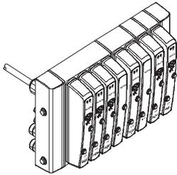
La transmisión de señales entre la unidad de mando y el terminal de válvulas se realiza a través de un cable multifilar preconfeccionado o con una conexión multipolo de confección propia. De esta manera, la instalación resulta mucho más sencilla.
