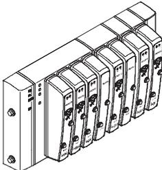
La transmisión de datos a un PLC está a cargo de un nodo de bus de campo. De esta manera, es posible obtener una solución de dimensiones compactas en su parte neumática y electrónica.
