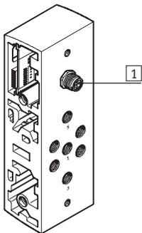
Utilizando el módulo de ampliación con alimentación de tensión eléctrica por separado (códigos V y C), es posible obtener hasta nueve zonas de tensión eléctrica, respetando la cantidad máxima de posiciones de válvulas y de bobinas.
