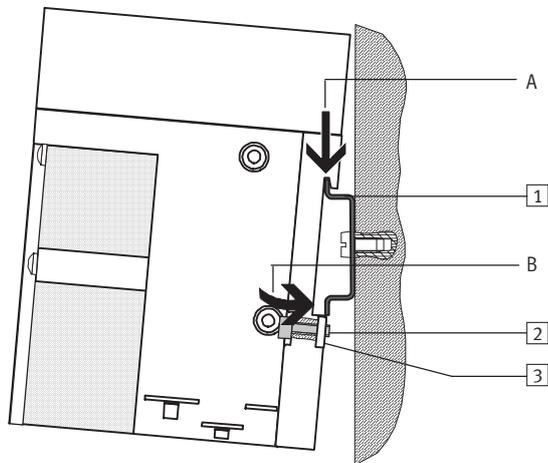
El terminal de válvulas CPA se cuelga en el perfil DIN (ver flecha A). A continuación se gira el terminal y se fija mediante la pieza de bloqueo (ver flecha B).
