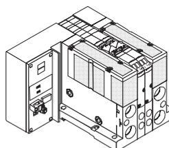
Terminal de válvulas AS-Interface con alimentación adicional
