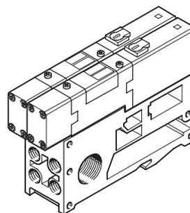
En el caso de las válvulas MAXI, las zonas de presión diferentes se consiguen intercalando una placa ciega. En el ese caso, la alimentación se realiza a través de la placa de adaptación.
