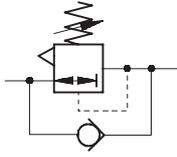
Para controlar la fuerza de los cilindros es posible montar un regulador entre la placa de base y la válvula correspondiente. Este regulador mantiene constante la presión de salida del lado secundario independientemente de las oscilaciones que sufra el lado primario.
