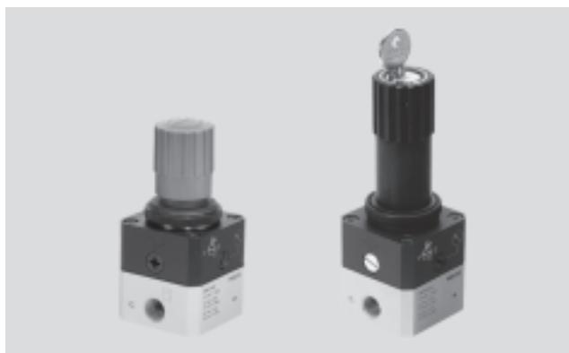
El regulador de precisión permite regular la presión de trabajo (lado secundario) mediante una membrana que actúa sobre el asiento principal, con lo que se consigue una característica de regulación mejor.
