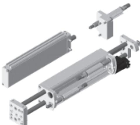
El cilindro y el tope adicionales permiten avanzar hasta una posición intermedia indistinta entre las dos posiciones finales del módulo lineal. Ello es posible tanto partiendo de la posición
