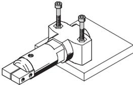
Mediante taladros, tornillos y tuercas de fijación
