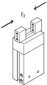
Aseguramiento de la fuerza de sujeción, cierra sin presión: en el siguiente diagrama constan las fuerzas del muelle  $F_F$  de la pinza paralela HGP-...-G2.
