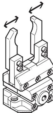
Los tiempos de apertura y de cierre [ms] aquí indicados fueron medidos a temperatura ambiente, con una presión de funcionamiento de 6 bar y con la pinza sin dedos adicionales y montada en posición horizontal. Al
