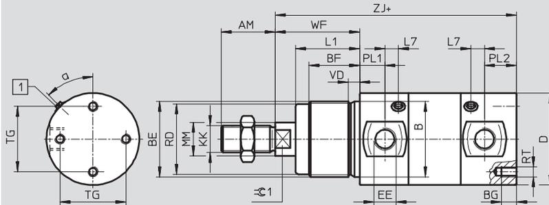
1 Tornillo de regulación para Amortiguación en las posiciones finales
