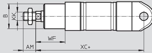
MQ-K3: Culata posterior corta sin fijación basculante, con rosca interior en el vástago
