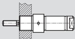
Fijación mediante tuerca hexagonal
