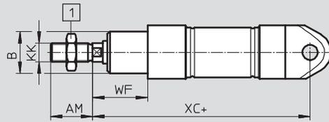
MQ-K3: Culata posterior corta sin fijación giratoria, con rosca interior en el vástago
