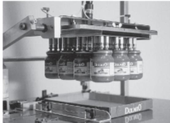
Ein großes Anwendungsgebiet der Vakuumtechnik ist die flexible Automatisierung:
