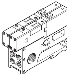
Bei MAXI-Ventilen werden Druckzonen durch das Einlegen einer Verschluss-scheibe gebildet. Die Einspeisung erfolgt dann über die Adapterplatte.
