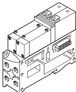
Das Bilden von Druckzonen für unterschiedliche Drücke, auch Vakuum, erfolgt bei MIDI-Ventilen durch einen Block „Druckzonen-einspeisung“. Die niedrigeren Drücke sollen knotennah eingespeist werden.
