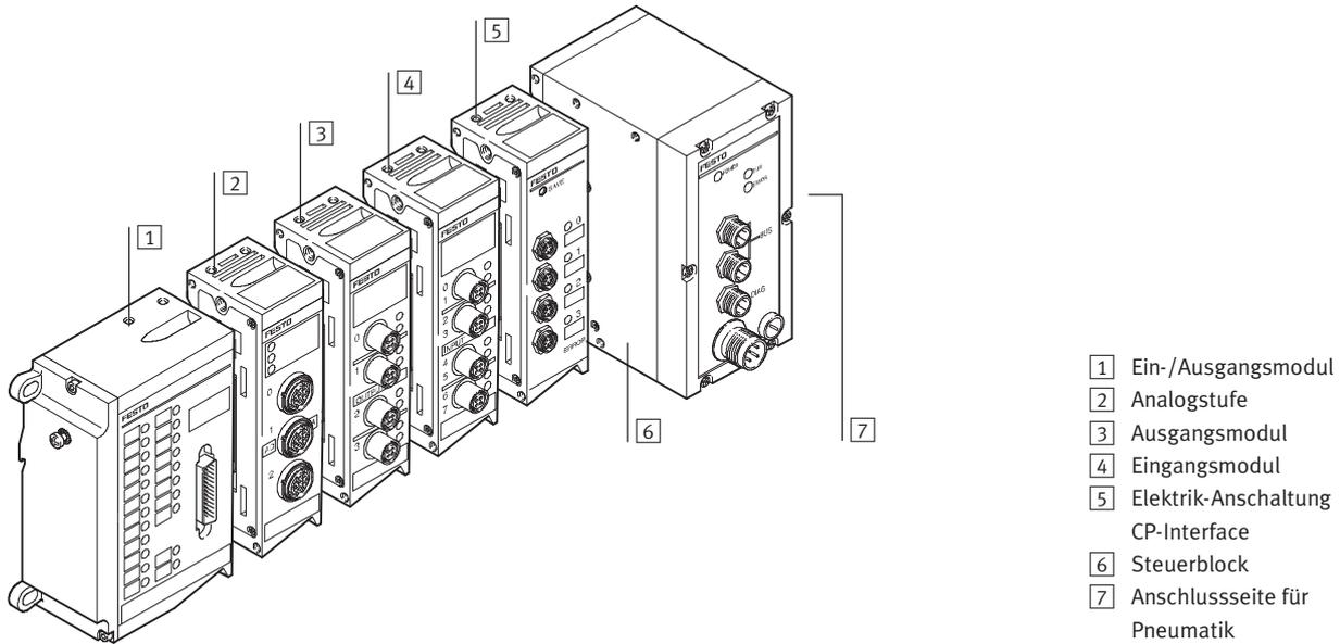
Die modulare elektrische Peripherie für Typ 03/04 ist mit Steuerblock bestückbar. Neben der Ansteuerung der Ventile und Ausgänge werden auch die zugehörigen Sensor-Rückmeldungen auf der elektrischen Peripherie zusammengefasst und autark mit der integrierten SPS verarbeitet. Über den Feldbus sind zusätzliche Erweiterungen und Vernetzungen möglich.
