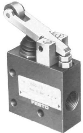
Diese Ventile werden verwendet, um eine vorwählbare Durchflußmenge während eines Bewegungsablaufes zu verändern. Damit kann z. B. eine vorwählbare Ausgangsgeschwindigkeit bei einfach- und doppeltwirkenden Zylindern während des Laufes verändert werden.
