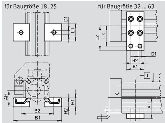
1 Position der Mittenstütze im Bereich des Profilrohrs frei wählbar
