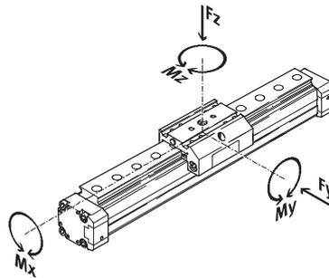
Wirken gleichzeitig mehrere der unten genannten Kräfte und Momente auf die Achse ein, müssen neben den aufgeführten Maximalbelastungen folgende Gleichungen erfüllt werden:
