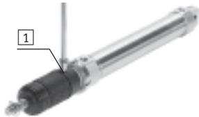
Der Faltenbalgbausatz ist ein leakage-freies System. Um das Ansaugen von unerwünschten Medien zu vermeiden, ist die Zu- bzw. Abluft des Bausatzes über eine Atmungsbohrung im Anbindungsteil **1** gefasst. Der Bausatz schützt die Kolben-
