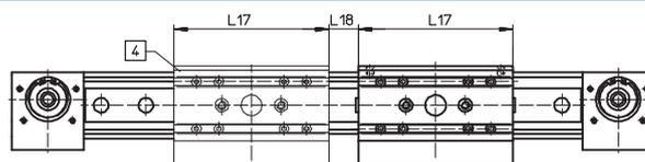
Bei einer Zahnriemenachse mit Zusatzschlitten reduziert sich der Arbeitshub um die Länge des Zusatzschlittens und den Abstand zwischen beiden Schlitten.
