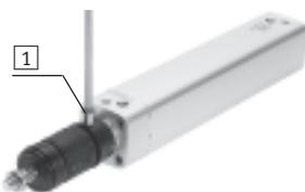
Der Faltenbalgbausatz ist ein leakage-freies System. Um das Ansaugen von unerwünschten Medien zu vermeiden, ist die Zu- bzw. Abluft des Bausatzes über eine Atmungsbohrung im Anbindebauteil **1** gefasst. Der Bausatz schützt die Kolben-
