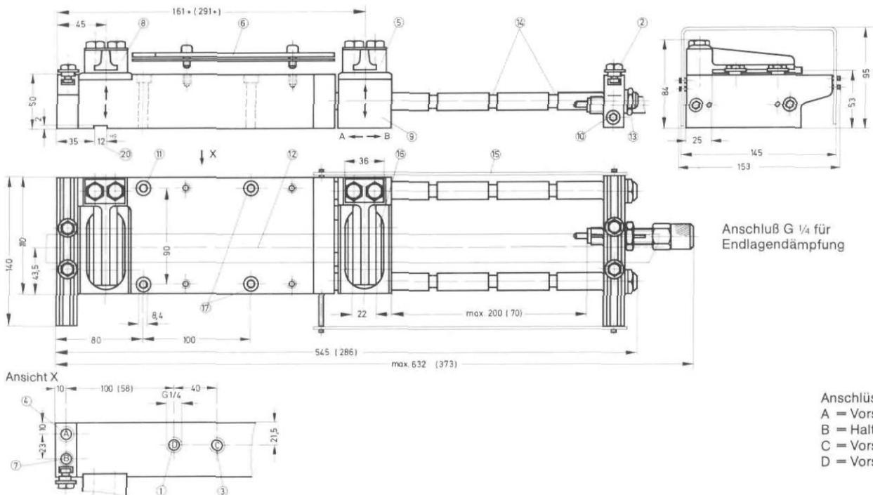
Typ BV-200-125 C (nur zwei Befestigungsbohrungen), BV-200-250 C und BV-200-350 C
