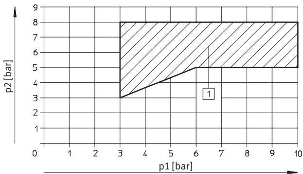
1) Arbeitsbereich für Ventile mit Steuerluftversorgung extern
