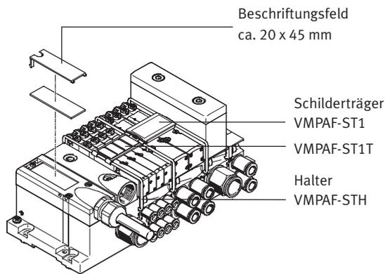
Zur Beschriftung der Ventile kann an jedem Anschlussblock ein Schilderträger VMPAF-ST1 (Teile-Nr. 546 228, Code T im Bestellcode, mit Papierschild bestückbar) oder VMPAF-ST1T (Teile-Nr. 544 422, mit Bezeichnungsschildern IBS-9x20 bestückbar) montiert werden. Alternativ oder ergänzend dazu können großflächige Bezeich-
