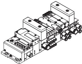
Die Kommunikation zu einer übergeordneten SPS übernimmt ein integrierter Feldbusknoten. Somit lässt sich eine Lösung kleinbauend in Pneumatik und Elektronik realisieren.
