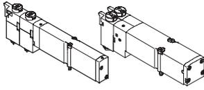
MPA-F bietet umfangreiche Ventilfunktionen. Alle Ventile sind mit Kolbenschieber und patentiertem Dichtprinzip ausgestattet welches hohe Dichtheit, einen großen Druckbereich und lange Lebensdauer ermöglicht. Sie besitzen zur Leistungssteigerung eine pneumatische Vorsteuerung. Die Versorgung erfolgt über eine Steuerluftversorgung.
