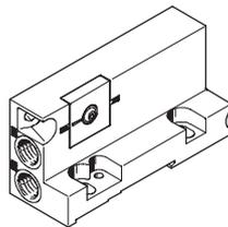
Die Endplatten mit Wahlschalter haben die Abgangsrichtung der Anschlüsse zur Vorderseite der Ventilinsel. Dies ermöglicht für die gesamte Insel eine Zusammenfassung aller Anschlüsse in einer Abgangsrichtung. Die Besonderheit der rechten Endplatte liegt im Wahlschalter,
