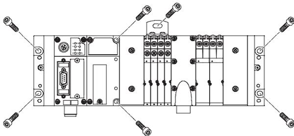
Die MPA-F Ventilinsel wird mit sechs M6-Schrauben auf der Befestigungsfläche angeschraubt. Die Montagebohrungen befinden sich an der linken Endplatte (CPX) und an der rechten End-
