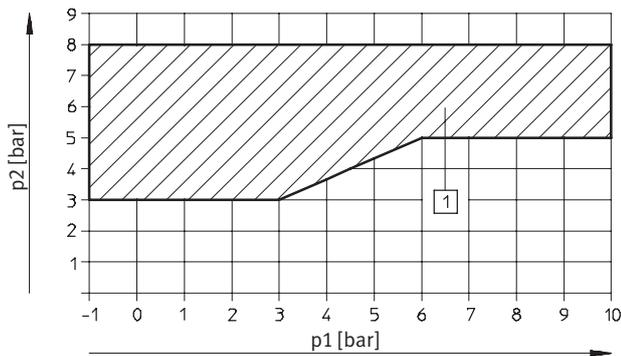
1) Arbeitsbereich für Ventile mit Steuerluftversorgung extern
