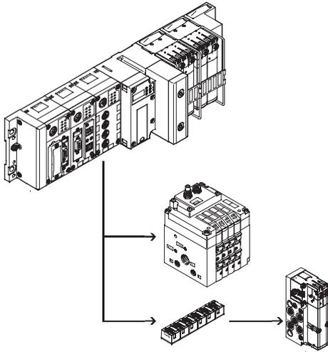
Die optionale Strangerweiterung bietet die Möglichkeit, weitere Ventilinseln und E/A-Module an den Feldbusknoten des CPX-Terminals anzuschließen. Es können verschiedene Ein- und Ausgangsmodule und CPV-SC, CPV-, CPA-Ventilinseln angeschlossen werden.
