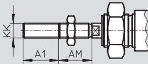
K6 – Verkürztes Kolbenstangen-Außengewinde
