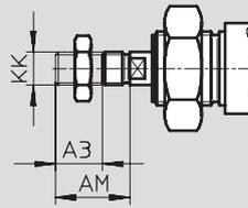
K3 – Innengewinde an der Kolbenstange
