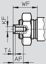
K5 – Sondergewinde an der Kolbenstange
