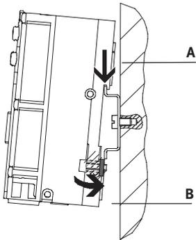
Im rückwärtigen Profil der CPX-Verkettungsblöcke ist die Hutschienenmontage eingepreßt. Über die Hutschienenbefestigung lässt sich das CPX-Terminal auf der Hutschiene verriegeln. Das Terminal CPX wird dazu in die Hutschiene eingehängt (siehe Pfeil A).
