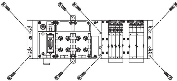
In den Endplatten des CPX-Terminals, der Ventilinsel und im Pneumatik-Interface sind Befestigungslöcher für die Wandmontage vorgesehen. Für längere Ventilinseln stehen zusätzliche Befestigungen für das CPX-Terminal zur Verfügung. Diese Befestigungen unterscheiden sich je nach Ausführung des CPX-Terminals (Kunststoff oder Metall).
