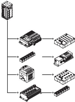
Die Elektrik-Anschaltung CPX CP-Interface erstellt die Verbindung zu CP-Modulen des Installations-system CPI über fertig konfektio-nierte Kabel. Die E/A-Daten der angeschlossenen Ventilinseln mit CP-Strangerweiterung und CP-Ein- und Ausgangsmodule wer-den an den angeschlossenen CPX-Bus-knoten und somit über Feldbus an die übergeordnete Steuerung übertragen.
