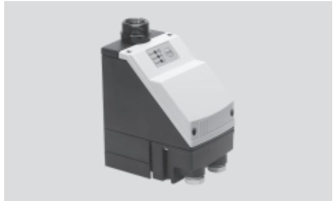
Kondensat gelangt durch die Anschlussbohrung im Boden der Filterschale in das angebaute Kondensatablassventil und wird dort in einem Behälter gesammelt. Wenn der maximale Füllstand erreicht ist, erkennt dies ein kapazitiver Sensor. Das Kondensat entweicht durch das sich öffnende
