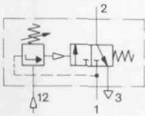
Das Ventil wird eingesetzt, wenn ein druckabhängiges Signal zum Umschalten einer Steuerung benötigt wird, z. B. beim Erreichen eines minimalen Spanndrucks bei Zylindern. Die Druckeinstellung wird an der Einstellschraube vorgenommen. Sobald dann das am Anschluß 12 anstehende Steuersignal den eingestellten Druck erreicht, wird das angebaute 3/2-Wegeventil betätigt. Umgekehrt schaltet das Ventil zurück, wenn das Signal an 12 den eingestellten Druck unterschreitet.
