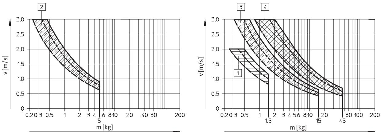
Für jeden Stoßdämpfer sind drei Kraftkurven eingezeichnet. Für Zwischenwerte muss gemittelt werden.
