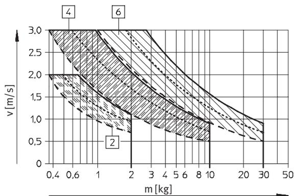
Für jeden Stoßdämpfer sind drei Kraftkurven eingezeichnet. Für Zwischenwerte muss gemittelt werden.
