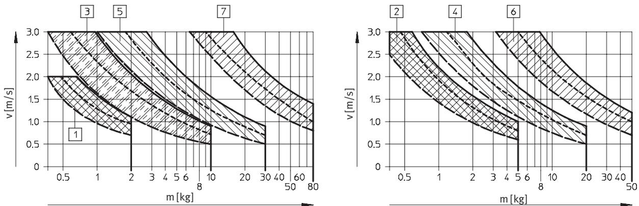
Für jeden Stoßdämpfer sind drei Kraftkurven eingezeichnet. Für Zwischenwerte muss gemittelt werden.
